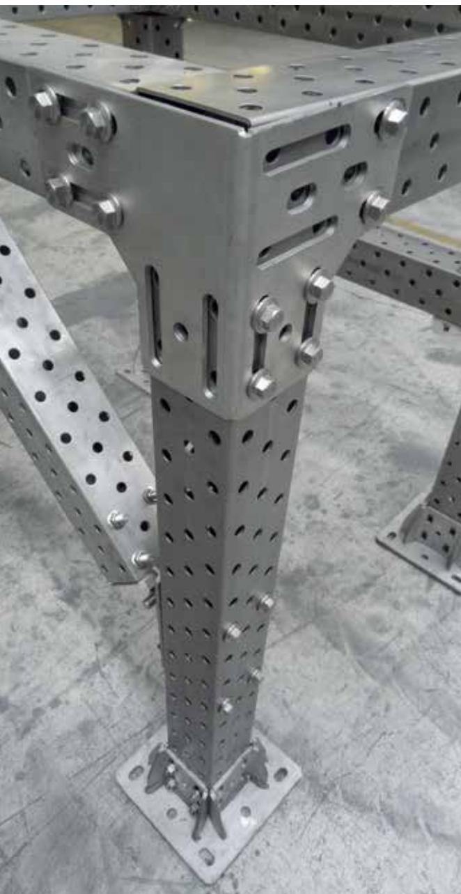
ProINOX mega yük destek sistemleri için tasarlanmış kaynaklı çelik imalatlara alternatif, modüler ve paslanmaz çelikten imal edilen profil sistemleridir.
