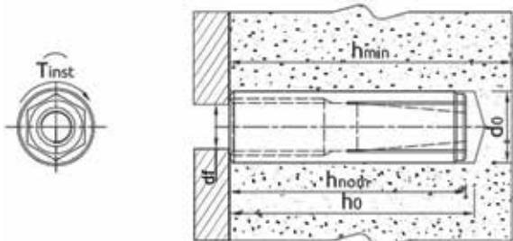
■ Oluklu manşon ve iç kama bileşenleri montajı kolaylaştırır. / Slotted sleeve and internal drop in component together facilitate easy setting and expansion.
