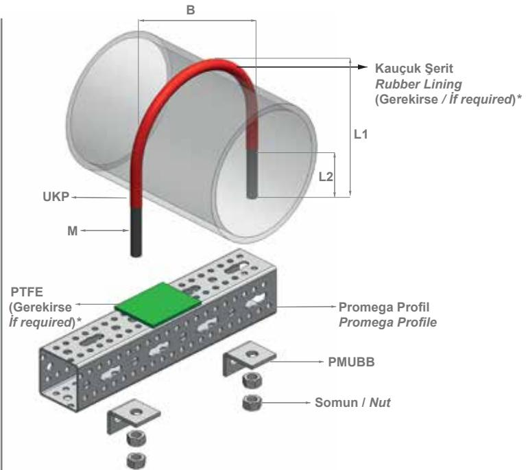
\* Eğer boru malzemesi profil ve kelepçeden farklı ise oradaki teması kesmek için PTFE ve kauçuk şerit kullanılabilir. Bu ürünler gerekli ise sipariş için lütfen danışın.
